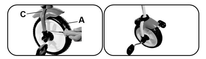
3.Infilare l'asta direzionale M nell'apposito foro sul telaio spingendo a fondo.
