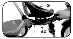
8.Infilare l'anello protettivo negli appositi supporti e provare la chiusura ad incastro frontale. Montare il coprisedile e legarlo al triciclo. Infilare le aste della capote ed avvitare le boccole per bloccarla.
